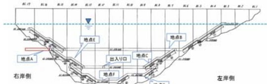
図-1 Sダム監査廊の断面図
