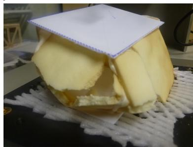
写真2 载荷試験により崩壊した模型
