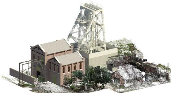
図2 完成した万田坑の建築情報モデル
