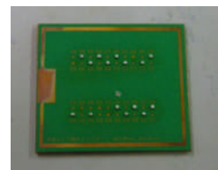
図 1 リフロー加熱直後の基板試料
