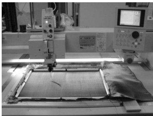
図2. 刺しゅう機によるプリフォームの製作
