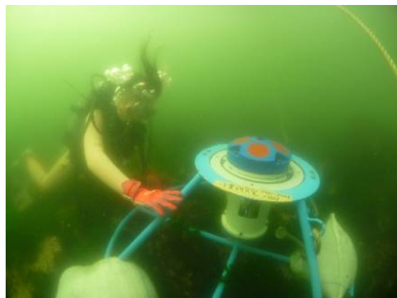
図2 1200kHz ADCP の海底設置状況 (スキューバダイバーにより土嚢で固定を行う。)
