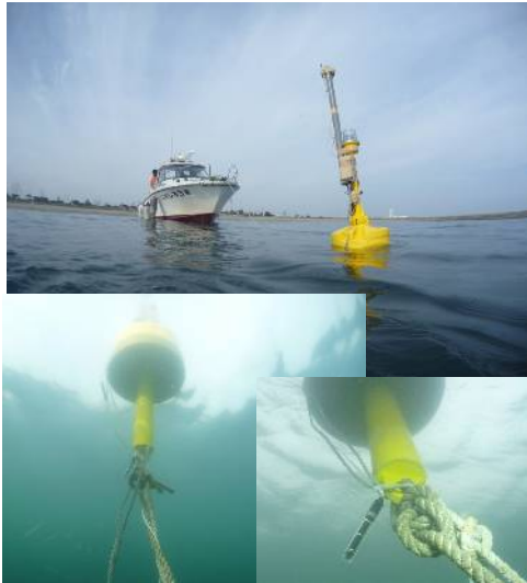
図8 海洋観測データ無線伝送ブイの設置 (温度・塩分センサー,無線LAN送受信器搭載)
