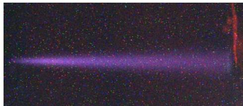
図3 CCDカメラによって観測された空気の発光分布。ビームは左から右に向かって空气中を通過している。予想よりも多いことが指摘された。これらの成果は、「電子線による空気の発光とビームモニターとしての応用」という題で、第9回日本加速器学会で発表した。
