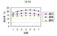
全体的な傾向としては、屋外>屋根>屋内の順になっている。しかし、屋根条件と屋内条件では、表層部分の含水率が低く、内部が高い傾向がみられ、上面側と下面側でほぼ対称な水分傾斜を示しているのに対して、屋外条件では、上面側より下面側のほうがより高い傾向がみられた。
