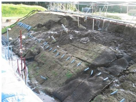
図8 パイピング発生後のすべり破壊
