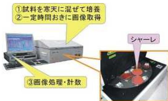
図1 以前に開発した生菌数迅速計測装置
