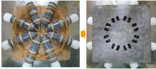
図1 マウスを入れたプラスチックチューブと遮へい鉛
