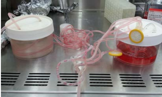
図6-1 構造体内部を培養液で還流する簡易型バイオリアクター(現在開発段階)
