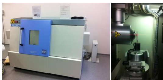
図1. 左:マイクロCTスキャナ(SMX-160CTS, 島津製作所) 右:家兎腰椎終板試験片用撮像治具。
