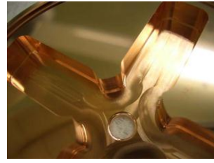
図 2 磁場増大の大きい空洞の構造
