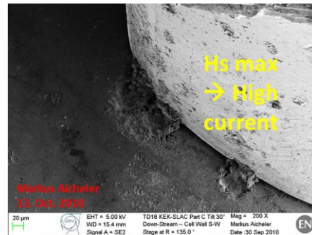
図 4 高電界試験後の高磁場部の SEM 写真
