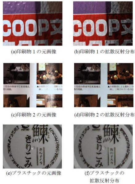
図5 印刷物の反射特性の分離結果
