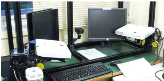
図8 液晶プロジェクタの画素単位で光線の色を変え、さらに光の強度を時間変調して、光線情報をより詳細に区別できるようにした照明系と単眼カメラを用いる実験装置。
