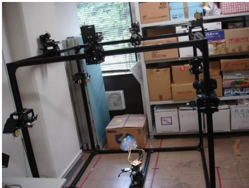
図 1：空間内を飛び交う光線の位置と方向を計測する Light Field 計測装置（独自に開発）
