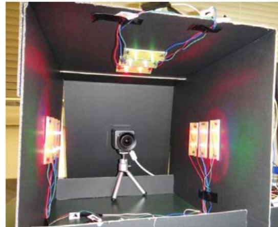
図 3 本課題で構成した照明系とカメラからなる装置
