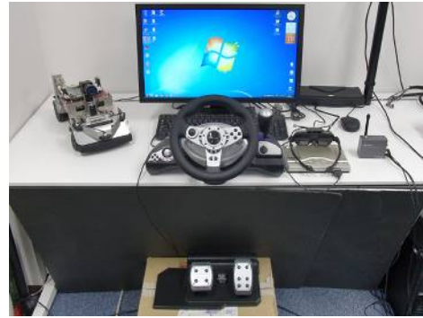
図2 遠隔運転システム
