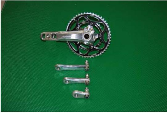
図3. 通常のクランクと試作した自由回転分節
