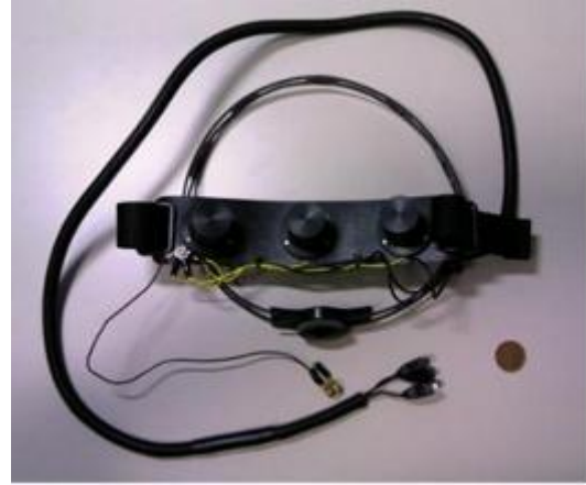
図 3 : ドライ電極。サイズ比較のため右下に 10 円玉を置いている。
