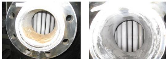
図2 蒸気発生器加熱部のスケール付着状況（左：H22/未処理、右：H23/8kHz 電磁処理）
