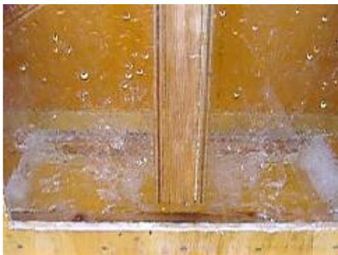
下降風量を増やすとしぶきが激しく飛散する
