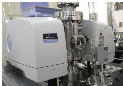
図 1. フーリエ変換型赤外分光光度計とその光路に設置したナノ粒子生成装置。中間赤外に透明なビューポートを持つ特型である。
