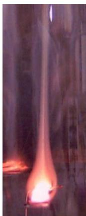
図 2. 典型的なナノ粒子からなる煙の写真。生成した粒子は熱対流により成長しながら上昇する。
