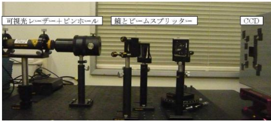
図2：可視光によるマッハツェンダー型干渉計の構成。右の端の箱が CCD である。
