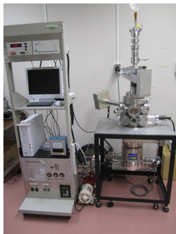
図 4. 製作した VSFG 測定用超高真空槽
