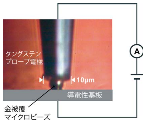
図4 1粒子マイクロビーズ導電性測定装置
