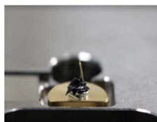
図8. 金の探針の取り付け
