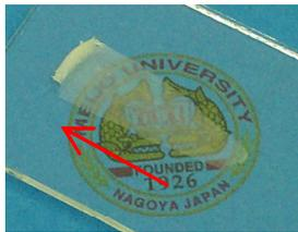
図 4 Ti<sub>1-δ</sub>O<sub>2</sub> ナノシート含有粘弾性ナノコンポジットを、矢印の方向に伸ばして成形した膜(厚さ 100 nm 以下)
