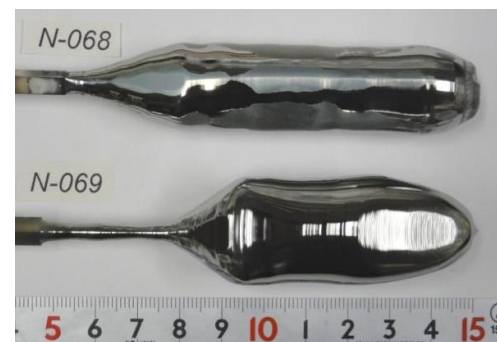
図2 図1の炉で育成した直径1インチGe単結晶
