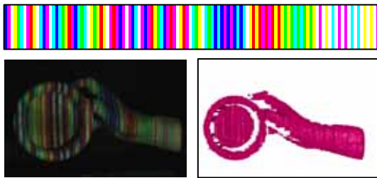
図3：(上) Hamming Color パターン， (左下) 計測画像，(右下) 復元結果
