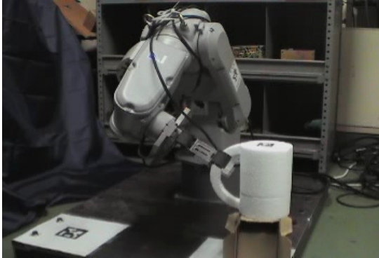
図4 アーム・ハンドシステムによる 三次元多指ケーシングの実行
