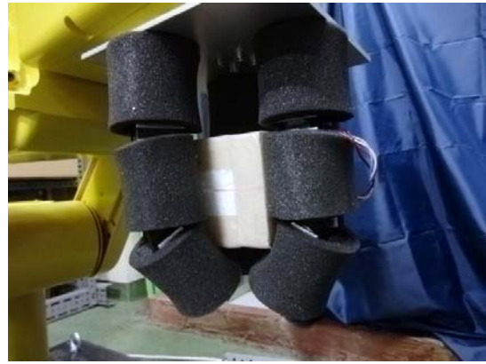
図6 三次元ケーシングベースト把持の実験
