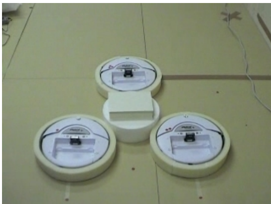
図5 二次元ケーシングベースト把持の実験
