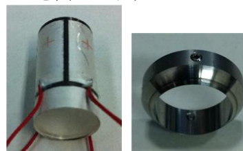
図1 製作した超音波モータのステータ(左)及びロータ(右)
