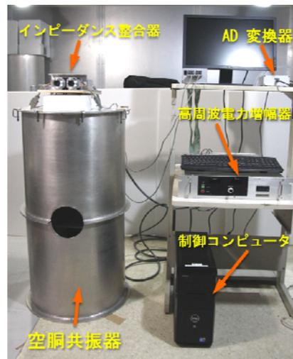
図4 試作加温装置写真
