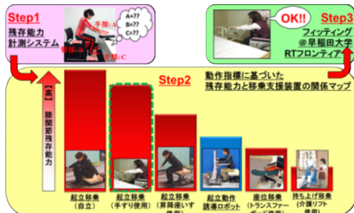
図 1 残存能力に適した移乗支援装置とロボット選定アルゴリズム
