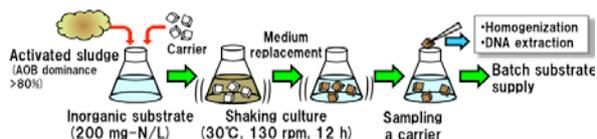
図 2 AOB による回分硝化試験
