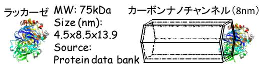
図 2. カーボンナノチャンネルに固定化されたラッカーゼのイメージ図
