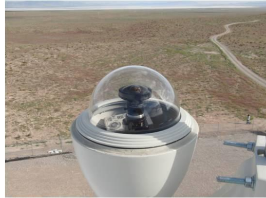
図 2 防犯カメラ用のハウジング内に設置された CCD カメラ
