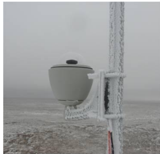
図 3 厳冬期の着霜のようす。霜の降りるこのような期間でもアクリルドームの可視性は確保されている。上である。
