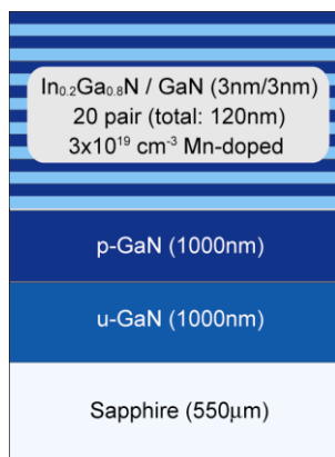
図3. 開発したInGaN-GaN超格子の構造
