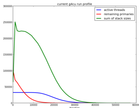
図 2: 粒子スタックサイズの変化。緑線が並列処理中の全粒子数(初期粒子+2 次粒子)、赤線が処理すべき初期粒子数、青線が、可動中のスレッド数。
