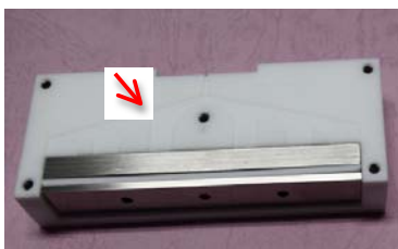
図3 スリットノズル。ガス導入用の溝を矢印で記した
