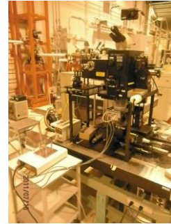
図4 SPring-8 の赤外ビームライン BL43IR にせん断セルを取り付けた様子。
