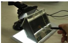
左図のようなセンサ実機を試作し、これに提案手法を実装した。本センサに対し、変位を加えたときの変化を用いて形状復元をした結果が左図である。これらの実験から、本装置が変位を定量的に計測できるセンサであることが明らかになった。
