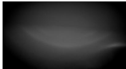
図 7: 800°C アニールした MgAl<sub>2</sub>O<sub>4</sub> 絶縁膜上 Co<sub>2</sub>FeSi 薄膜の成長後 RHEED 像.
