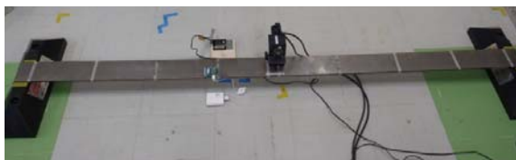
図4：2mの単純梁を用いた振動実験の様子
