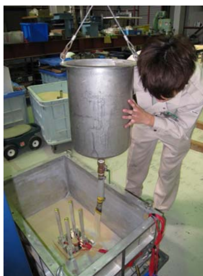
写真5 模型地盤作成状況
