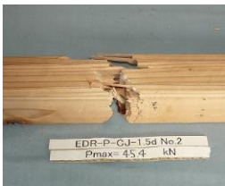
写真3 木材の引張破壊
