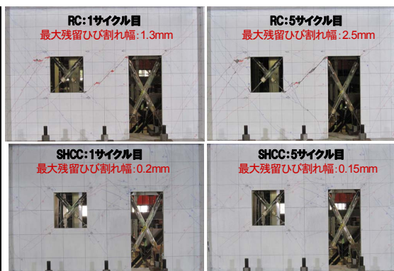
図5 1/400rad. 加力終了時の損傷状況
