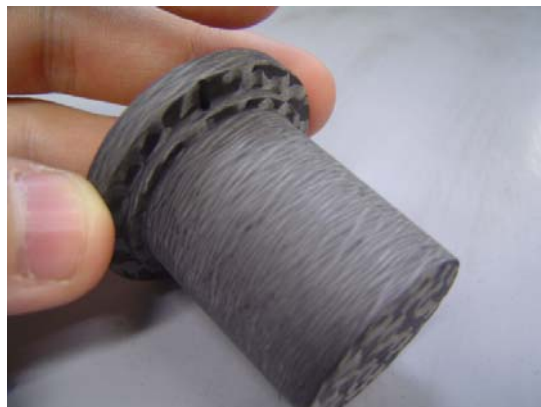
図 1 研究用 CFRP アブレータの製作
