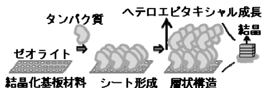
図1. 合成ゼオライトのモレキュラーシーブを用いたタンパク質結晶化法の概念図。
