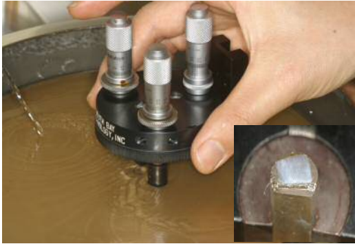
Fig. 2 : TRIPOD による研磨・試料加工
