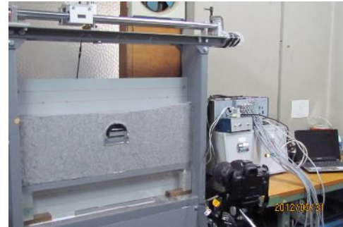
写真1 トンネル掘削模擬装置
